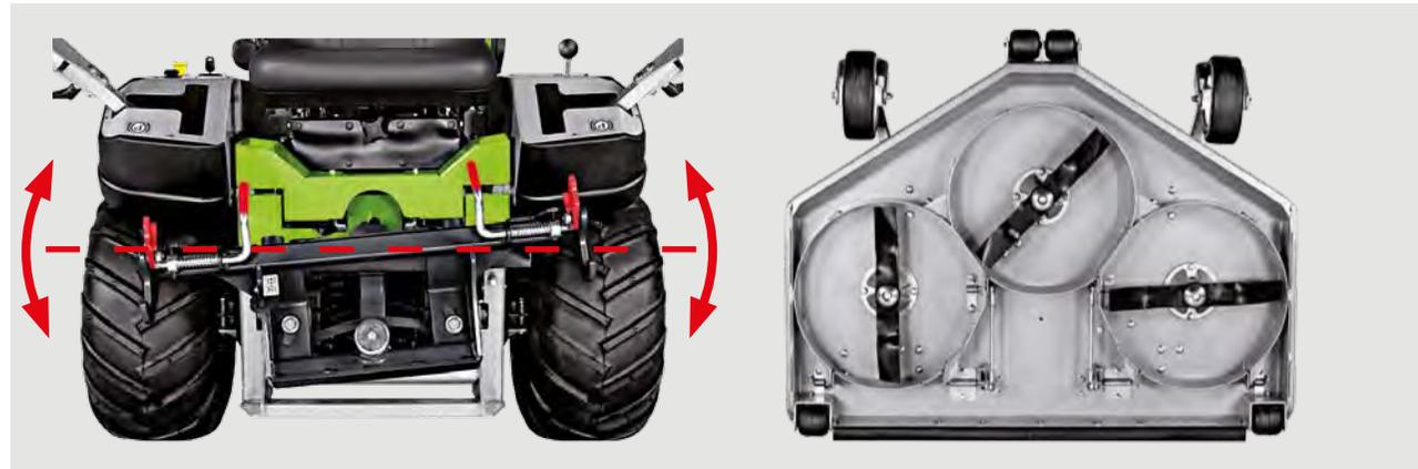
Das Mähdeck zu 132 cm ist mit 3 Messern aus gehärtetem Stahl ausgestattet. Die Messer sind auf leichten aber widerstandsfähigen Naben aus einer speziellen Legierung montiert und werden durch Schrauben und Tellerfedern, welche sie vor Schlägen schützen, befestigt.
