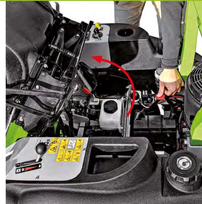
Der Sitz ist mittels einer Gasdruckfeder aufklappbar, was eine einfache und schnelle Inspektion und Wartung der Maschine erlaubt. Die Schmiernippel sind angezeigt und einfach zu erreichen.
