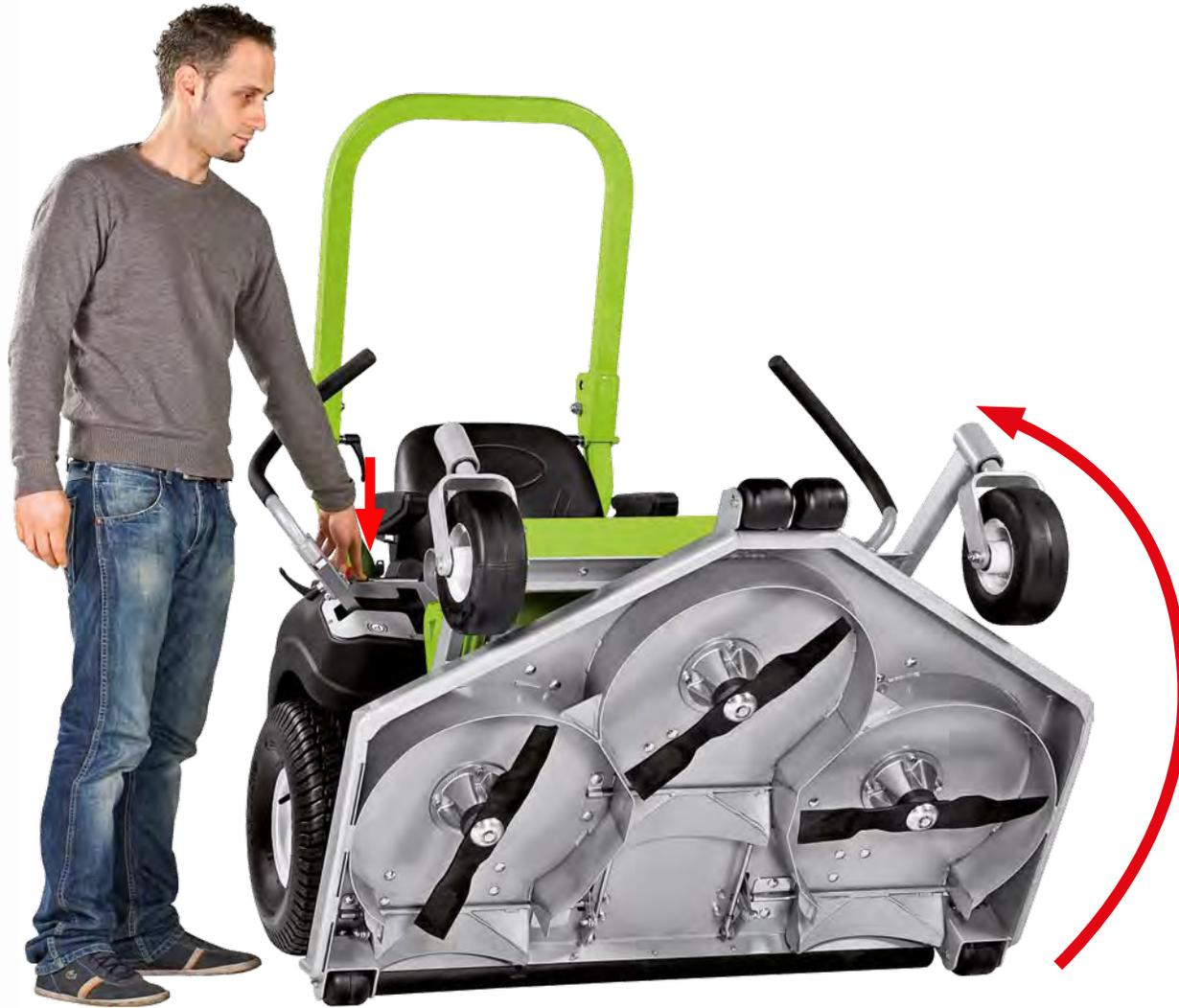
Die Reinigung des Mähdecks in der hochgekippten Position ist einfach und schnell.
