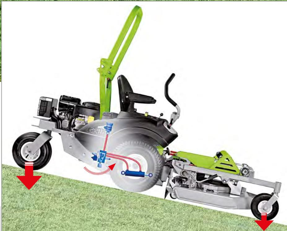
Ein weiterer Pluspunkt ist das „Anti-Lift“ System bei Arbeiten an Hanglage, mit dem der **FX 27** ausgerüstet ist.
