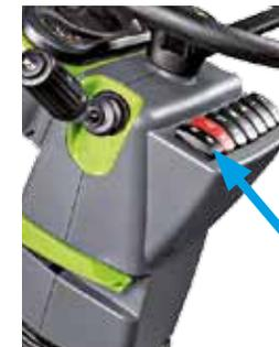
Die stufenlose, hydraulische Schnitthöheneinstellung des Mähdecks ist einfach und präzise, sie wird bequem mittels Druckknopfs elektrisch vom Fahrersitz aus bedient. **Kein Absteigen erforderlich!**
