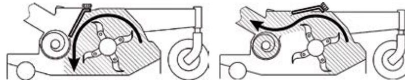
**Schlegelmäher cm 160 mit Sammeln anwendbar mit FD 2200 und FD 2200 TS.** Der Übergang von Sammel- zu Heckauswurfmodalität erfolgt in Sekundenschnelle, indem die Stellung eines Blechteils geändert wird, ohne die Messer zu wechseln.
