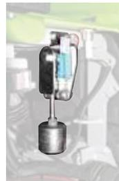
**Automatisches Stabilisationssystem, welches bei Bedarf das Sperren und Entsperrn des Differentials steuert** (es ist auch eine manuelle Betätigung möglich).
