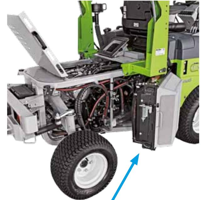
Der **Kühlblock lässt sich zur Vereinfachung der Wartung und Reinigung nach außen öffnen**. Er verfügt über **ein automatisches Umkehrsystem des Flusses des Kühlgebläses**, mit welchem die Oberfläche des Schutzgitters sauber bleibt. Dieses System gewährleistet eine konstante Kontrolle der Temperatur mit Hilfe des Temperaturfühlers.
