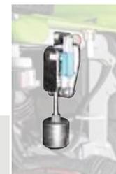
**Automatisches Stabilisationssystem** welches bei Bedarf das Sperren und Entsperrern des Differentials steuert (es ist auch eine manuelle Betätigung möglich).
