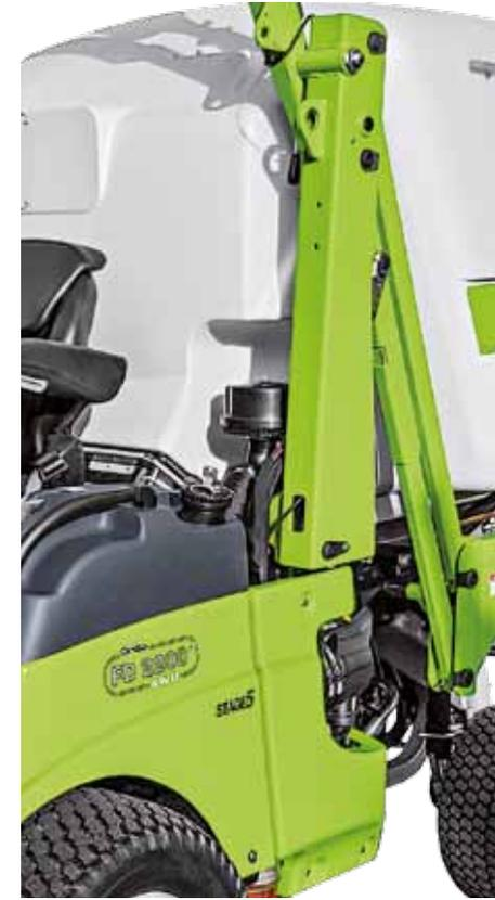
Der Vorfilter, Motorluftfilter, Kraftstofffilter, Dieseldekanter und Hydraulikölfilter **sind leicht zugänglich** wie auch die Batterie, der Riemenspanner und die elektrohydraulische Kupplung der Zapfwelle. Auch die **hydraulischen Komponenten** wie die Regelpumpe und die Zahnradpumpe sind leicht von hinten zugänglich.
