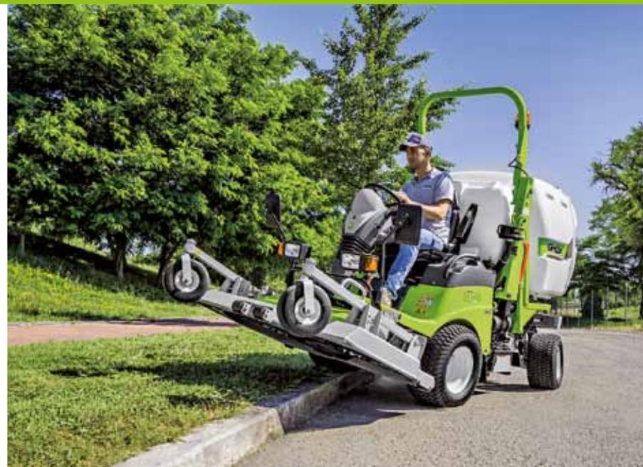
Die Grillo Modelle **FD 2200** und **FD 2200 TS** verfügen über eine Hochentleerung von **230 cm** und einen hinteren Überhang **30 cm** und der **FD 2200 TS** verfügt über eine Hochentleerung von **250 cm** und einen hinteren Überhang von **50 cm**: dies erlaubt das einfache Entladen auf alle Transportmittel.
