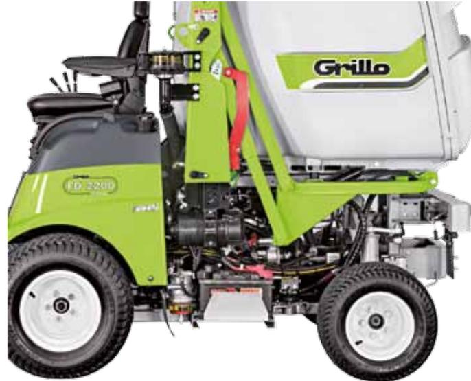
Der Vorfilter, Motorluftfilter, Kraftstofffilter, Diesel-Dekanter und Hydraulikölfilter **sind leicht zugänglich** wie auch die Batterie, der Riemenspanner und die elektrohydraulische Kupplung der Zapfwelle. Auch die hydraulischen Komponenten wie die Regelpumpe und die Zahnradpumpe sind leicht von hinten zugänglich.
