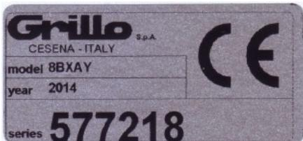
La motoazada está dotada de una placa con el número de bastidor de la máquina que se encuentra sobre el chasis, bajo la caja. Este numero es indispensable para cualquier intervención técnica y para solicitar los recambios.
