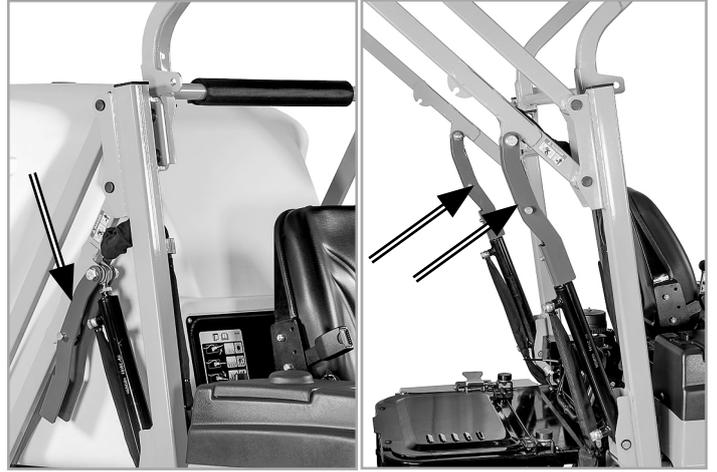
**⚠ ACHTUNG:** Wird die Wartung bei laufendem Motor und angehobenem Grasfangkorb durchgeführt, müssen die zwei rot lackierten Sicherheitsstangen auf den zwei Hydraulikzylindern, die sie stützen, eingefügt werden. Auf keinen Fall die Maschine mit angehobenem Grasfangkorb parken, ohne vorher die zwei Sicherheitsstangen eingefügt zu haben.
