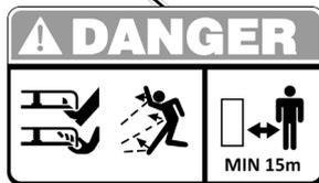
Gefahr durch scharfe Messer und Schleudergefahr durch drehende Messer
