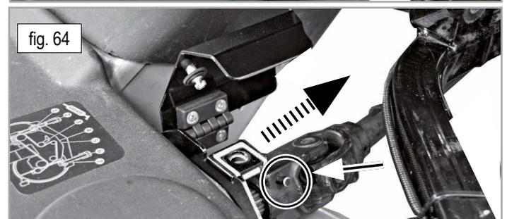
3. Die hinteren Bolzen an den Armen aushängen, indem sie nach außen gezogen und gedreht werden, um den Splint in der Höhlung zu blockieren (Abb. 65).
