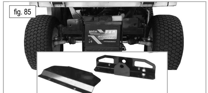
Die neue Batterie einfügen und die Kabel anschließen (**zuerst das positive ROTE, dann das negative SCHWARZE**), dann die Befestigungsschrauben anziehen, den Stoßfänger und den oberen Deckel wieder einbauen.
