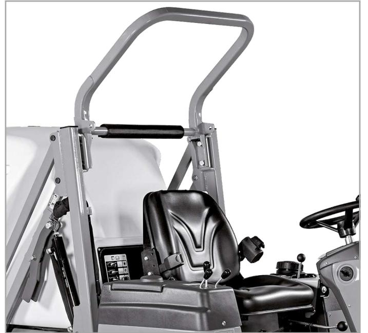
**⚠ ACHTUNG:** Beim Arbeiten muss der Überrollbügel immer festgeschraubt sein und auf keinen Fall heruntergeklappt werden. Der Sicherheitsgurt muss angeschnallt sein.
