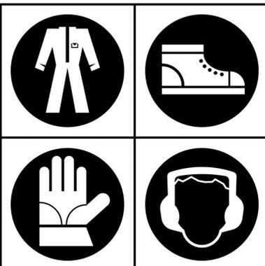
Vor der Benutzung der Maschine müssen obligatorisch die dafür vorgesehene Sicherheitskleidung angezogen werden: Körperschutzkleidung, Schutzhandschuhe, Sicherheitsschuhe, Gehörschutz.
