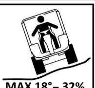
Umkippsgefahr der Maschine
