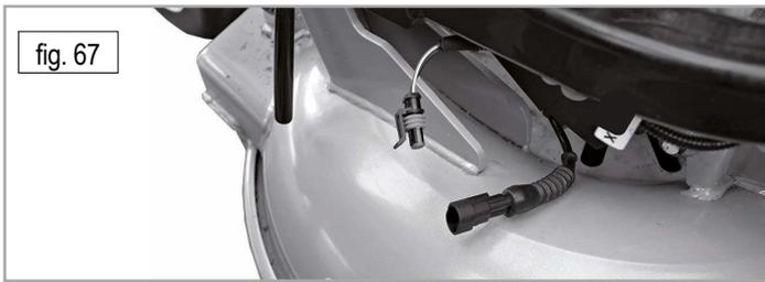
6. Das Mähwerk zum Abhängen von der Maschine nach vorne ziehen.
