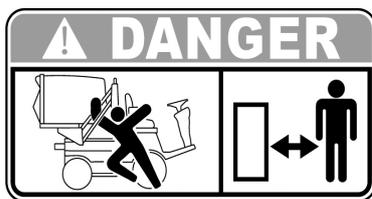
Der Grasfangkorb kann angehoben und gekippt werden; bei laufender Maschine den angemessenen Abstand halten.
