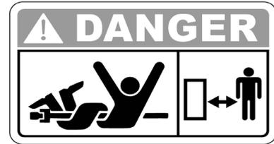
Die drehende Kardanwelle kann schwere Schäden an Personen zufügen. Nie Wartungsarbeiten bei laufendem Motor durchführen
